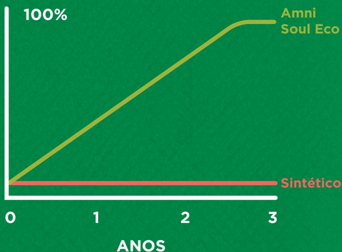
\*Baseado na norma ASTM D5511 - Método de teste padrão para determinar biodegradação anaeróbica de materiais plásticos sob condição de digestão anaeróbica com alto teor de sólidos. *Standard Test Method for Determining Anaerobic Biodegradation of Plastic Materials Under High-Solids*
